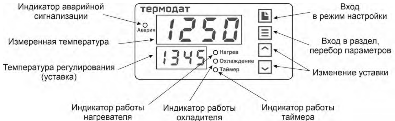
Рисунок 10 – Описание индикаторов и кнопок управления прибора Термодат-10K7-H
