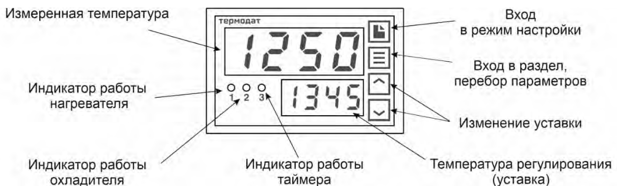
Рисунок 12 – Описание индикаторов и кнопок управления прибора Термодат-10K7-P4
