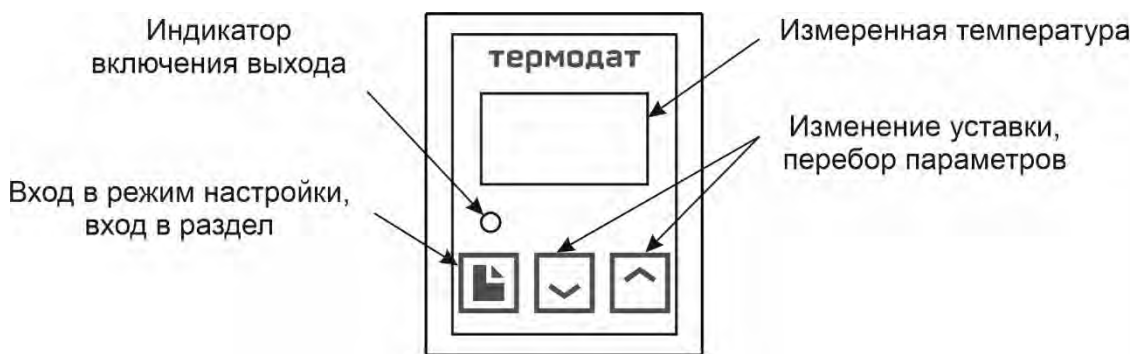
Рисунок 1 – Описание индикаторов и кнопок управления прибором
