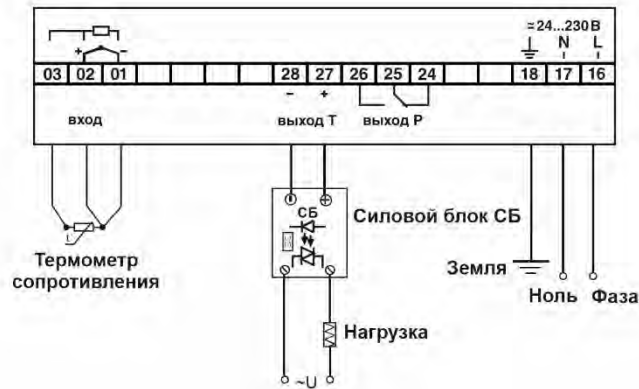
Рисунок 18 – Типовая схема подключения при использовании T выхода. Для напряжения питания 24В, контакт «N» – «-U», «L» – «+U».
