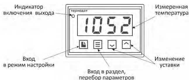
Рисунок 10 – Описание индикаторов и кнопок управления прибора 10М7 - P4
