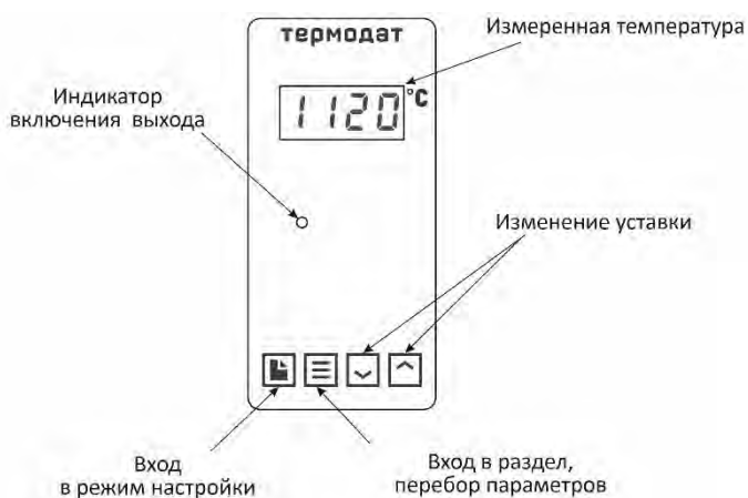
Рисунок 11 – Описание индикаторов и кнопок управления прибора 10М7 - К
