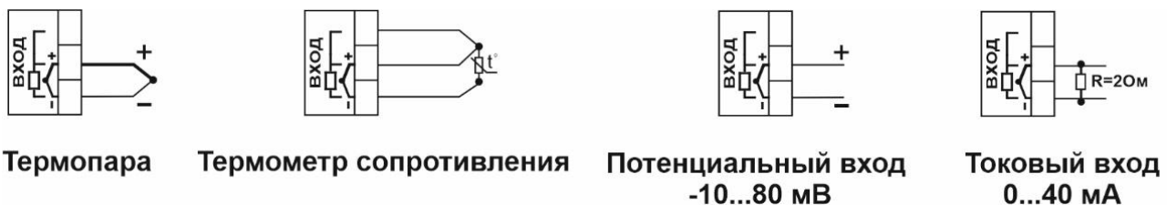
Рисунок 14 – Схема подключения датчиков температуры
