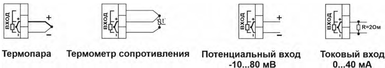
Рисунок 3 – Схемы подключения датчиков температуры
