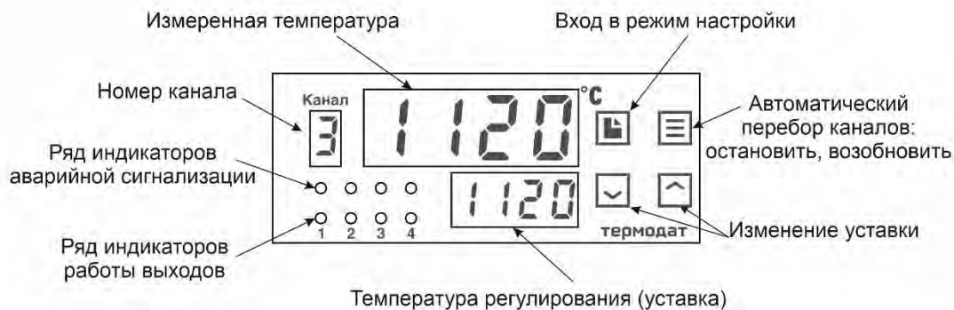
Рисунок 5 – Описание индикаторов и кнопок управления приборов 11М6-А...
