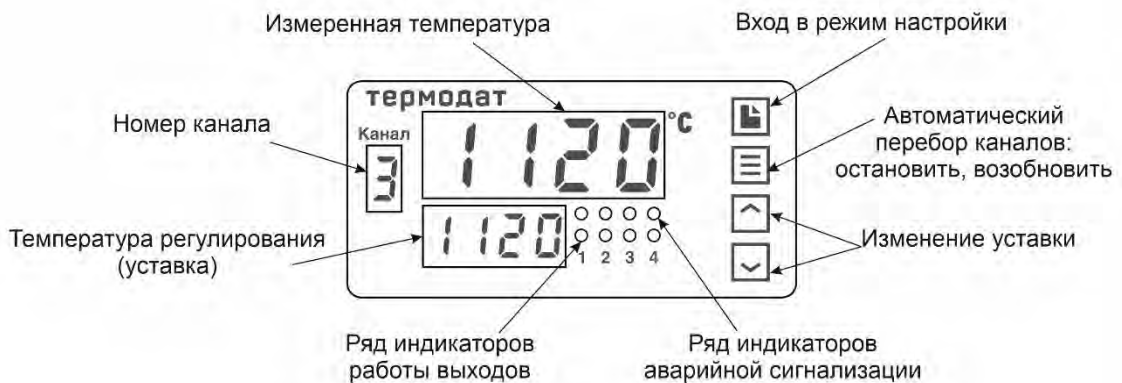
Рисунок 8 – Описание индикаторов и кнопок управления приборов 11М6-Н...
