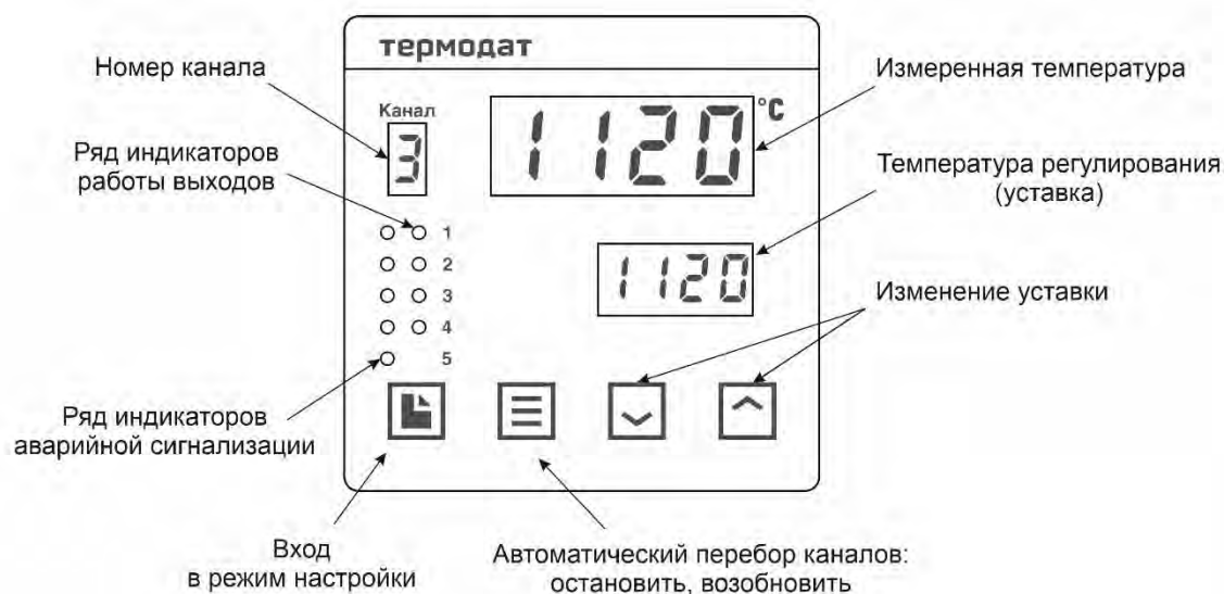
Рисунок 5 – Описание индикаторов и кнопок управления приборов 11М6-А...
