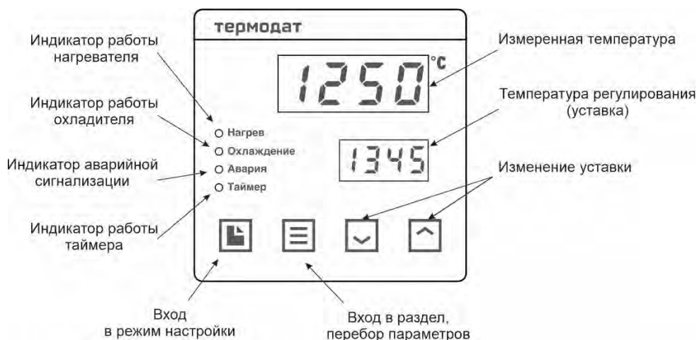
Рисунок 5 – Описание индикаторов и кнопок управления прибора 12К6-А...
