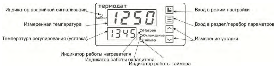
Рисунок 7 – Описание индикаторов и кнопок управления прибора 12К6-Н...
