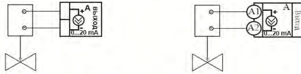
Подключение задвижки с электроприводом
