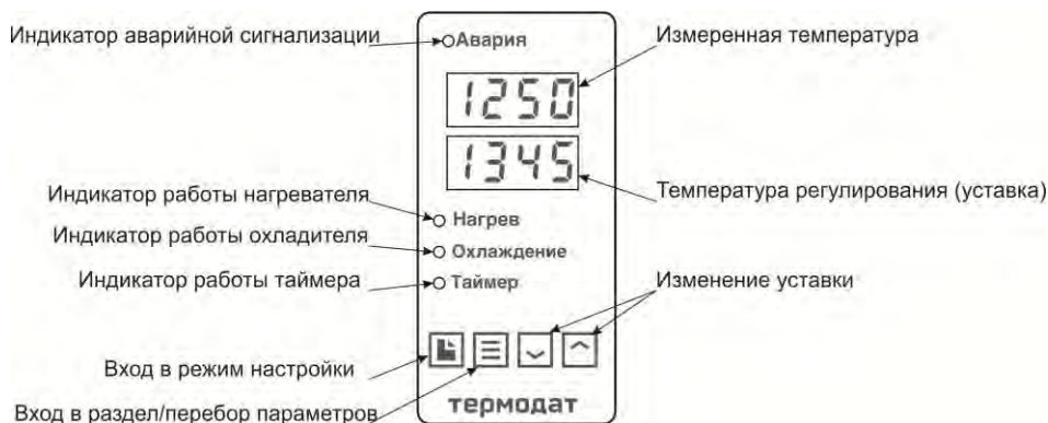
Рисунок 6 – Описание индикаторов и кнопок управления прибора 12К6-В...
