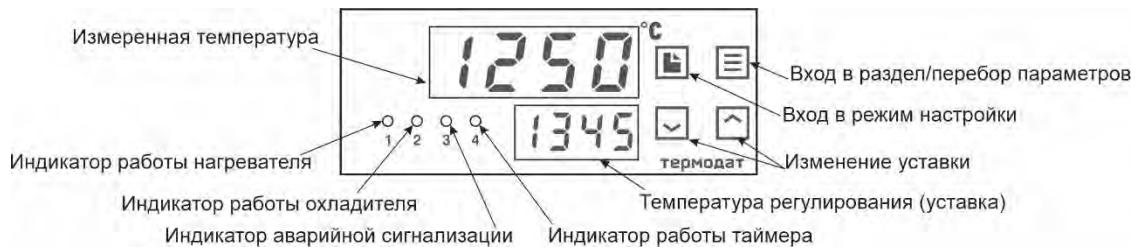
Рисунок 8– Описание индикаторов и кнопок управления прибора 12К6-Р6...
