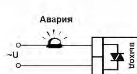
Подключение аварийной сигнализации
