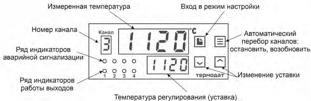
Рисунок 4 – Описание индикаторов и кнопок управления прибора Термодат-13К6-Р6..
