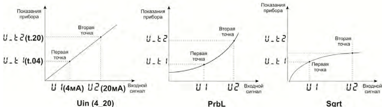
Рисунок 4. Показания прибора для входов типа «U.in», «4–20», «PrbL», «Sqrt».
