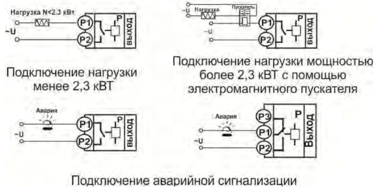
Рисунок 6. Схемы подключения релейных выходов.
