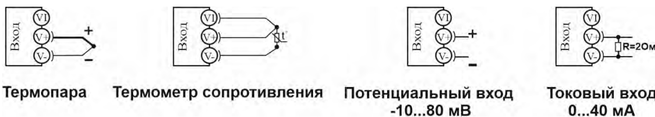
Рисунок 7 – Схемы подключения датчиков
