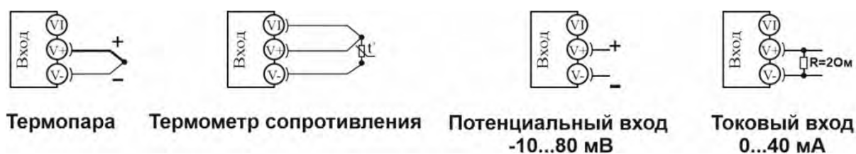
Рисунок 2 – Схемы подключения датчиков
