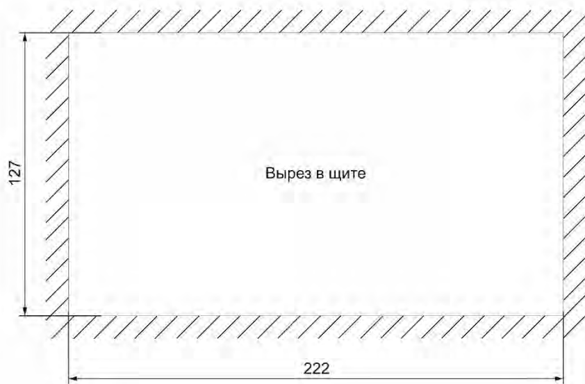
Рисунок 8 – Габаритные размеры основного блока прибора Термодат-29Е6/...../F
