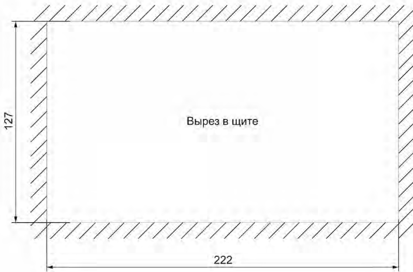
Рисунок 7 – Габаритные размеры основного блока прибора Термодат-30E1/.....F
