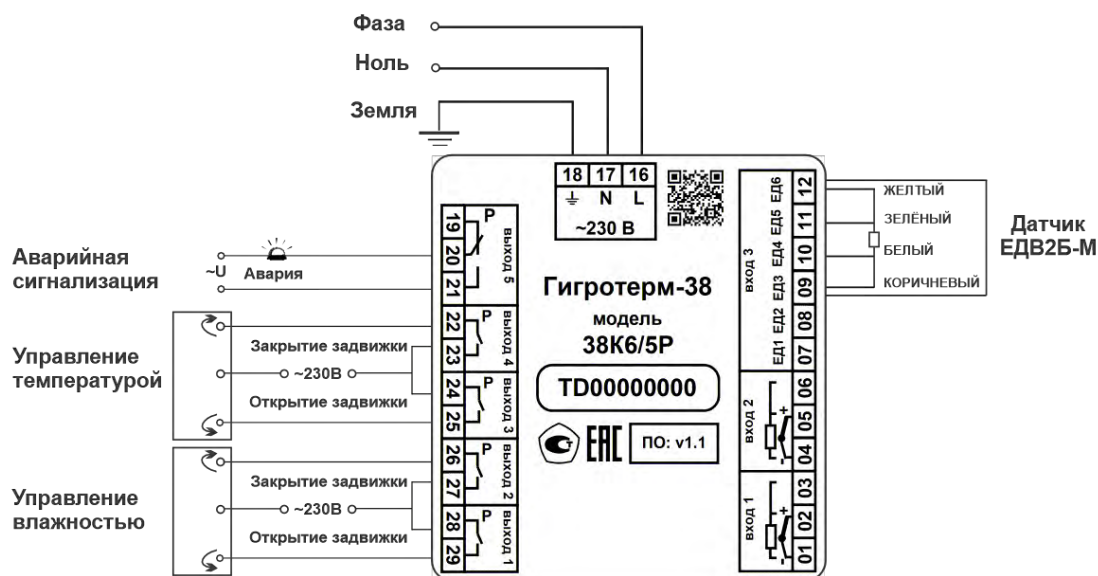
Рисунок 6 - Регулирование влажности и температуры с использованием электродвижек. Для измерения влажности и температуры применяется датчик ЕДВ2Б-М
