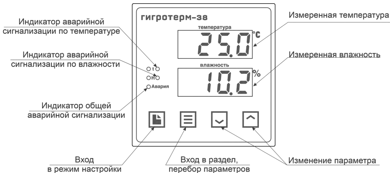
Рисунок 1 – Описание индикаторов и кнопок управления прибора
