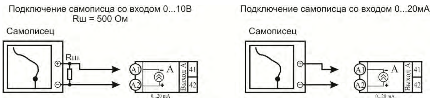
Рис 5.4 Типовые схемы подключения аналогового выхода
