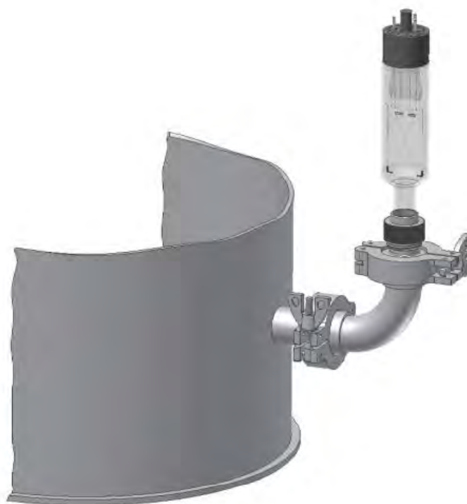
Схема подключения датчика ПМТ-2 к вакуумной системе
