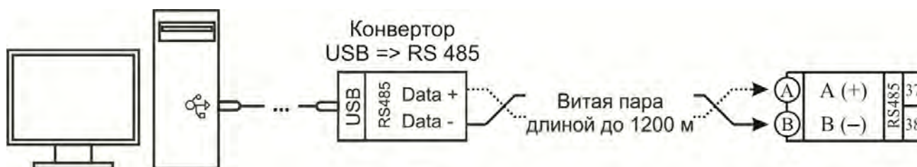
Рис 5.3 Типовая схема подключения прибора к персональному компьютеру.
