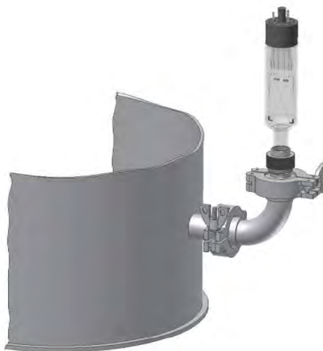
Схема подключения датчика ПМТ-2 к вакуумной системе
