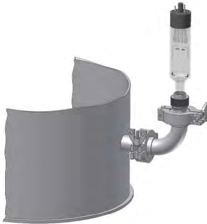
Схема подключения датчика ПМТ-2 к вакуумной системе
