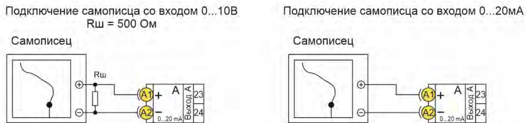
Рис 5.4 Типовые схемы подключения аналогового выхода
