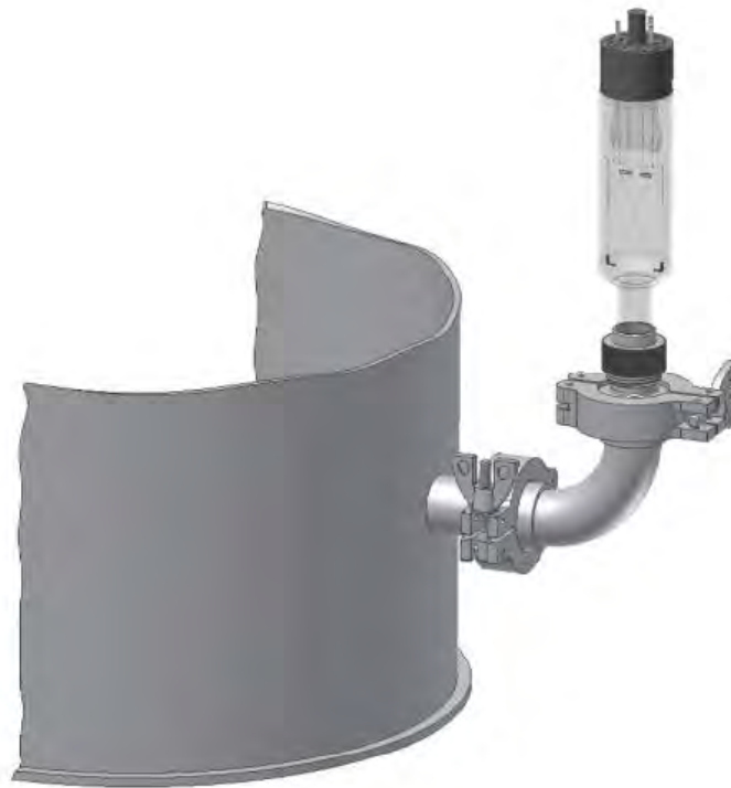
Схема подключения датчика ПМТ-2 к вакуумной системе
