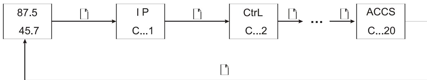
Выбор параметра на странице осуществляется нажатием на кнопку  $\cup$ . При этом на верхний индикатор выводится название параметра, а на нижний — его значение. Значение параметра изменяется при помощи кнопок  $\nabla$  и  $\Delta$ . Последовательное нажатие на кнопку  $\cup$  приводит к поочерёднему перебору всех параметров страницы и возврату к названию страницы.
