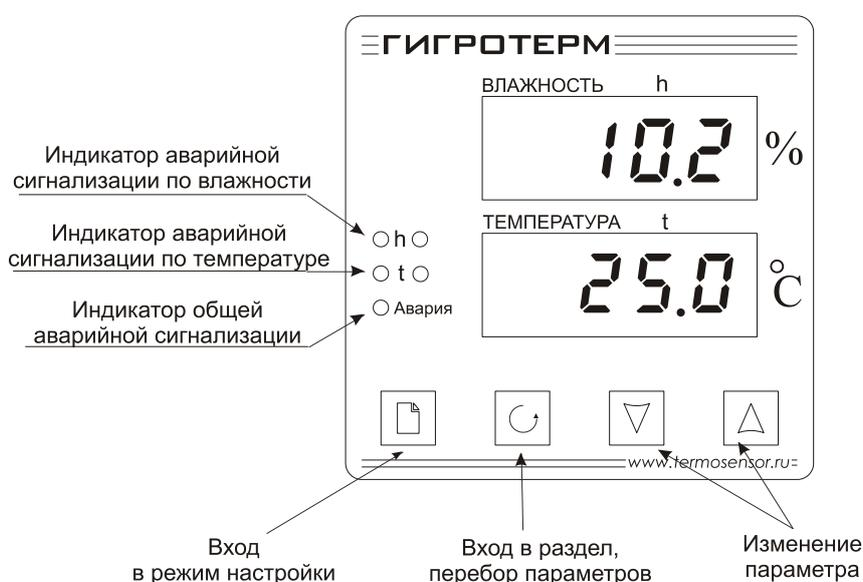
Если датчик не подключен или произошел обрыв датчика, то вместо измеренного значения температуры/влажности выводится надпись «ОБР».
