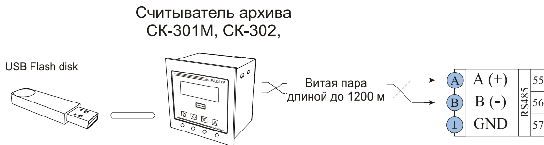
Рис 5.4 Типовая схема подключения прибора к считывателям архива.
