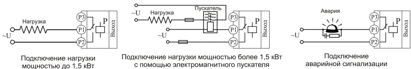
Рис.1 Использование релейного выхода
