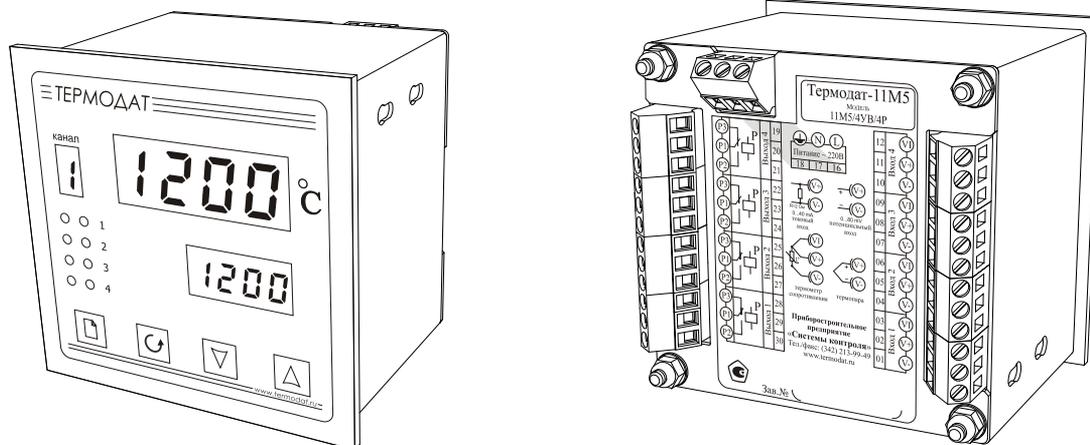
Термодат-11М5 может иметь два, три или четыре канала в зависимости от модели. Каждый канал имеет вход и соответствующее ему выходное реле. Входы предназначены для подключения термопар и термосопротивлений. Каждый выход может управлять нагревателем или охладителем или использоваться для аварийной сигнализации.
