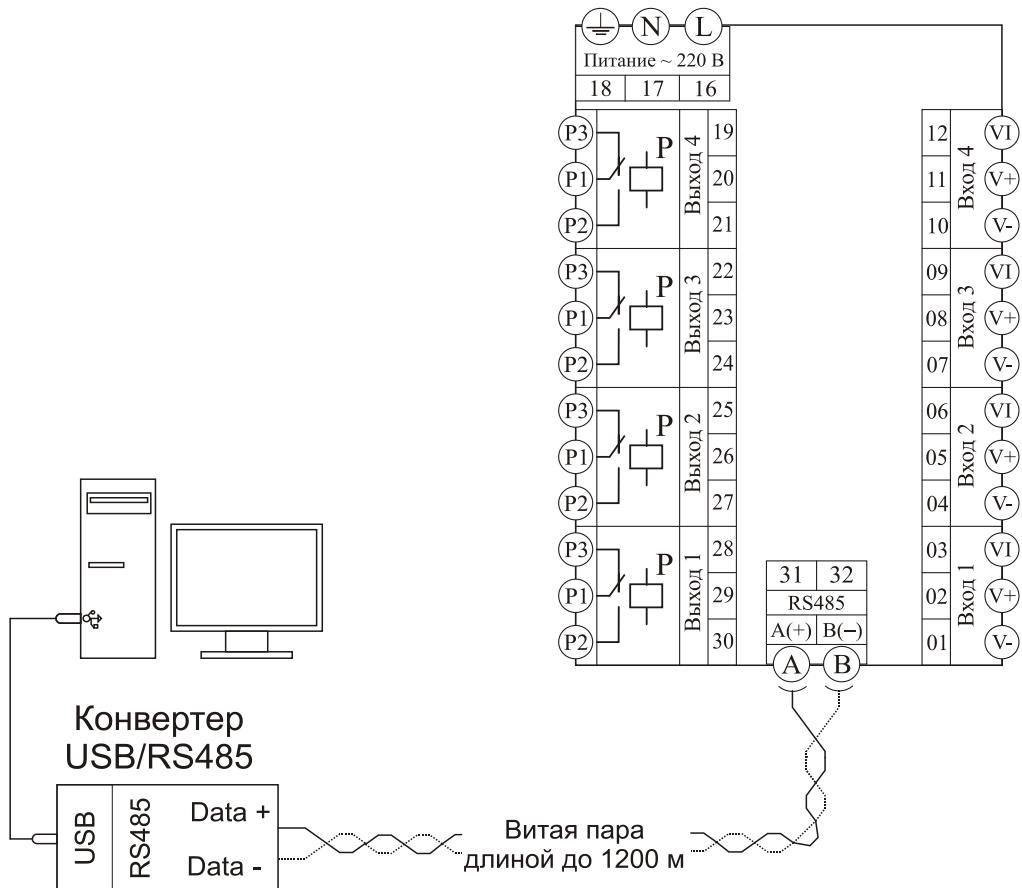
Рис. 4. Подключение к компьютеру (для приборов с интерфейсом)
