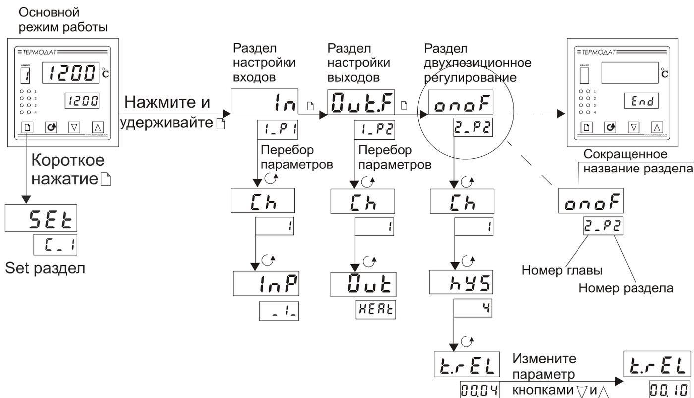
**!** Не спешите нажимать кнопки  $\nabla$  и  $\Delta$ . Нажатие этих кнопок приводит к изменению значений параметров. Нажимая кнопку  $\cup$ , просмотрите сначала все параметры в разделе. На нижнем индикаторе Вы увидите значения параметров, установленные ранее или установленные на заводе изготовителе.
