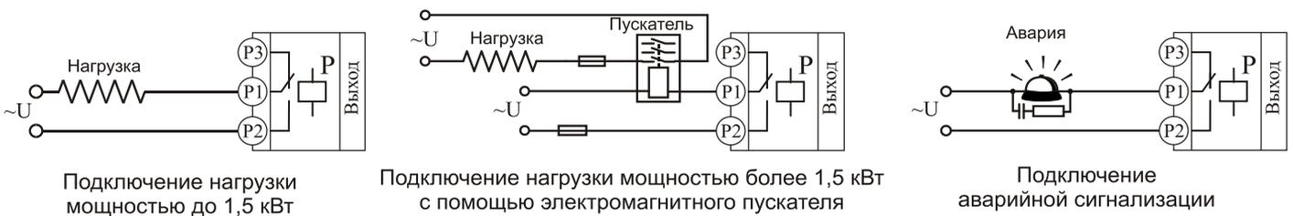
Рис.1 Использование релейного выхода
