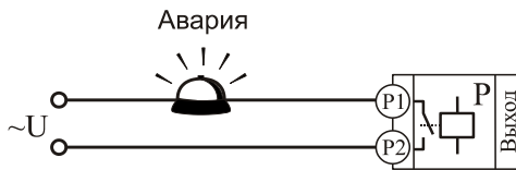
Подключение аварийной сигнализации
