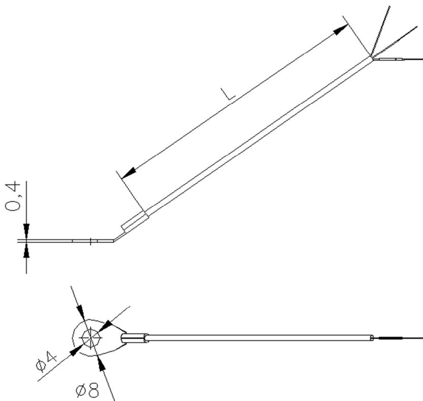
Бескорпусная конструкция – гибкий кабель, имеет в своем составе крепежное кольцо. Заделка чувствительного элемента выполнена термоусадочной трубкой.
