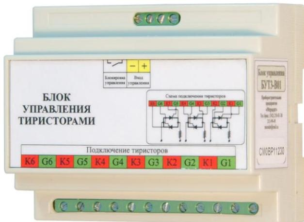
Блок БУТЗ-В01 предназначен для управления мощными тиристорами, с помощью которых производится коммутация напряжения на трехфазной нагрузке. Блок управления позволяет согласовать транзисторный выход регулятора «Термодат» с уже имеющимися в наличии силовыми элементами. Также блок может работать и с другими регуляторами. Встроенная схема управления обеспечивает включение тиристорov в «нуле» фазы и
