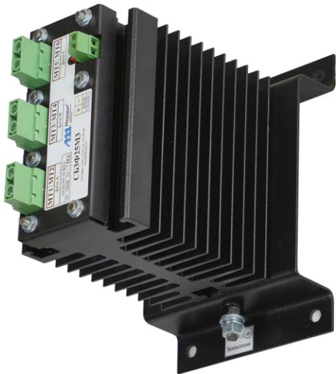
Силовой блок СБЗФ25М3 предназначен для плавного управления мощностью на трехфазной нагрузке мощностью до 28,5 кВт. В отличие от традиционных механических пускателей твердотельные силовые элементы не имеют ограничений по числу коммутаций и имеют несоизмеримо больший ресурс.
