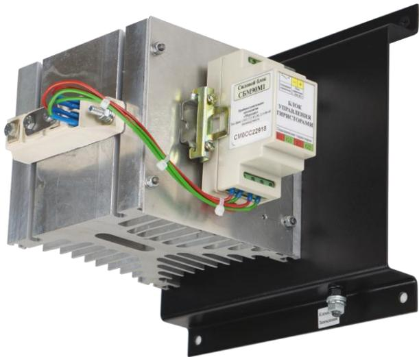
Силовой блок СБМ90М1 предназначен для плавного управления мощностью на однофазной нагрузке мощностью до 34,2 кВт. В отличие от традиционных механических пускателей твердотельные силовые элементы не имеют ограничений по числу коммутаций и имеют несоизмеримо больший ресурс. Встроенная схема управления обеспечивает включение силового элемента в «нуле» фазы и надежное его запираение, что позволяет свести помехи в сети к минимуму. Блок СБМ90М1
